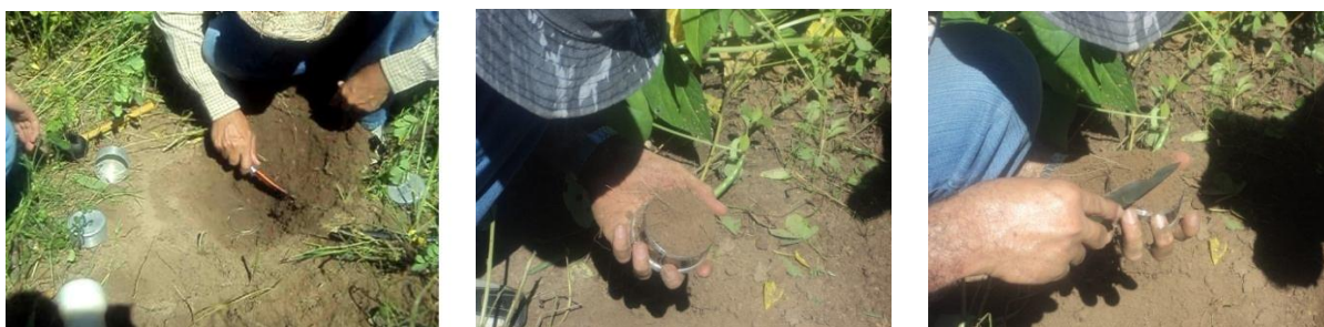
Figura 2. Coleta da amostra de solo pelo método do anel volumétrico.
