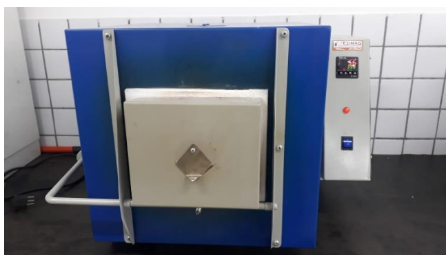
Figura 03: Forno de mufla utilizado no tratamento térmico. (Autoria própria).
