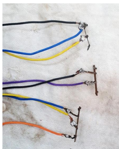
Figura 05: Solda nas amostras para realizar RET (Autoria própria).
