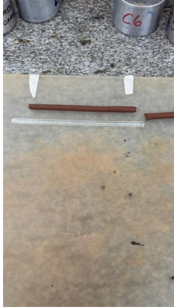
c) Formando o CP na espessura do bastão de vidro e com 10 cm
