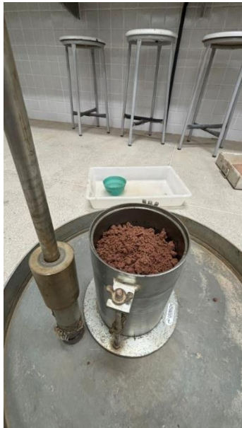
c) Procedimento para molda o CP
