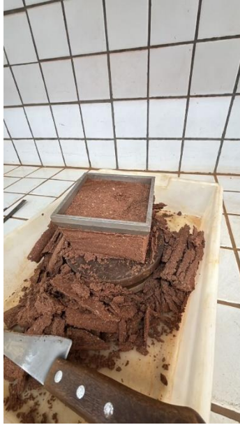
c) Procedimento de modelagem do CP
