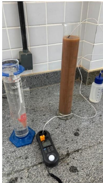
c) Medindo temperatura após leitura
