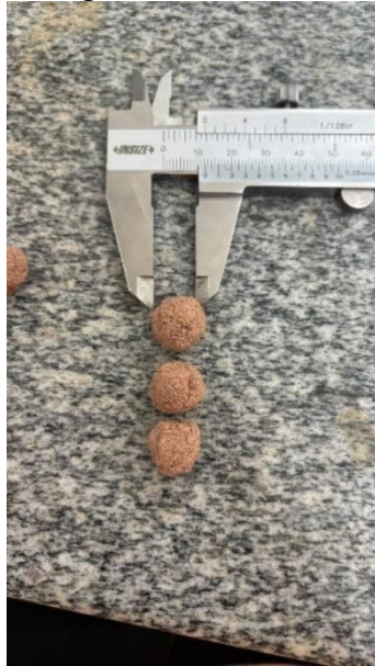
a) Amostras modeladas e secas na estufa
