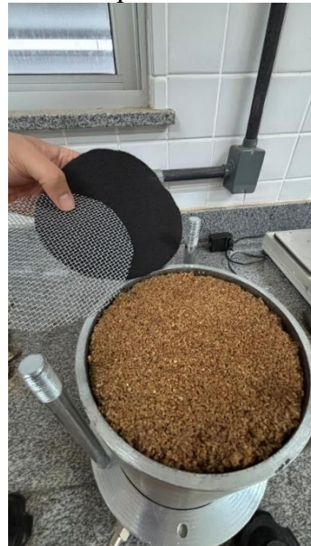
d) Montagem do permeâmetro
