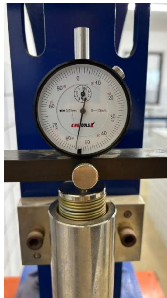
d) Relógio para medir a deformação
