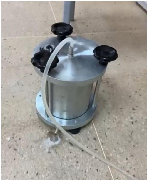
a) Permeâmetro com o solo saturado ensaio permeabilidade carga variável
