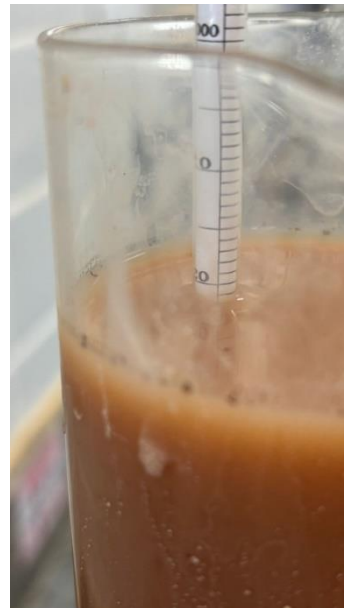
d) Densímetro dentro da proveta
