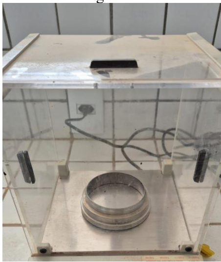
a) Molde do CP com 79,8 mm de diâmetro
