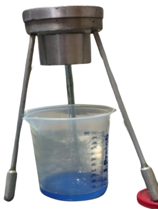
Figura 7. Copo Ford para realização da viscosidade.
