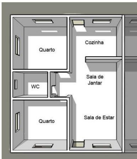
Figura 01: Paredes externas que constitui a envoltória da edificação.
