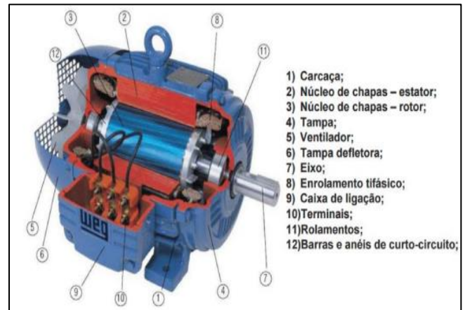
Fig. 1. Componentes de um motor de indução trifásico [13].
