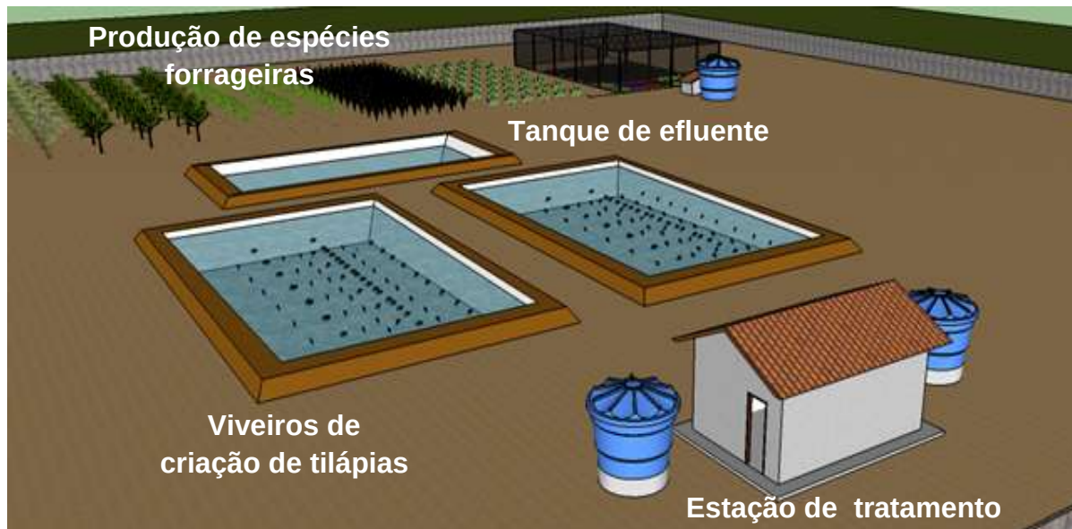
Figura 3. Esquema do sistema de tratamento de água salina e da produção agrícola integrada e sustentável utilizando rejeito salino como suporte hídrico. Fonte: Dados do acervo de pesquisa.
