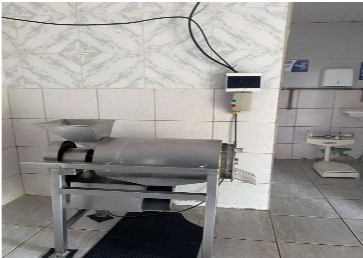
Figura 12 – Equipamento conhecido como despolpadeira, que remove a polpa de fruta dos seus caroços, sementes ou casca, na fábrica Nutripolpas, em Quixeré – CE.
