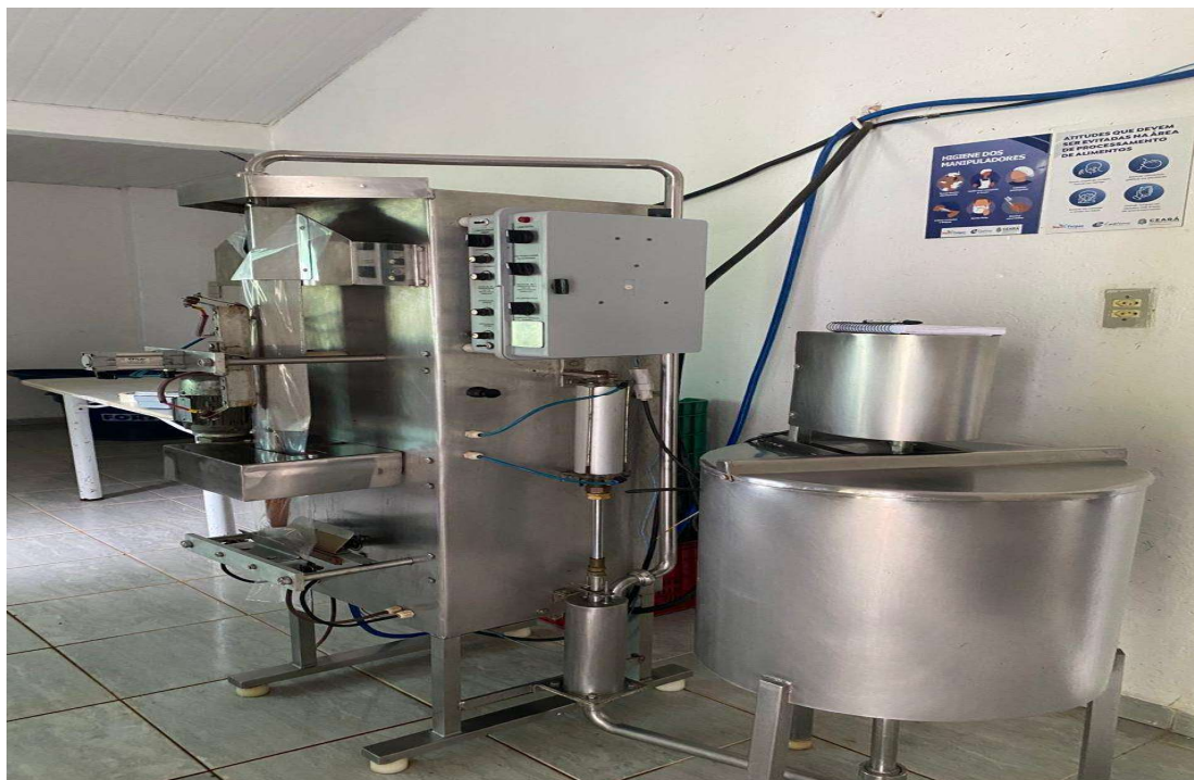
Figura 13 – Equipamento conhecido como envasadora, que serve para embalar produtos alimentares, geralmente líquidos, na fábrica Nutripolpas, em Quixeré – CE.
