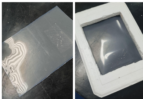
Figura 7 : Etapa de fixação da pasta plástica ao isopor. Fonte: Autoria própria (2025).
