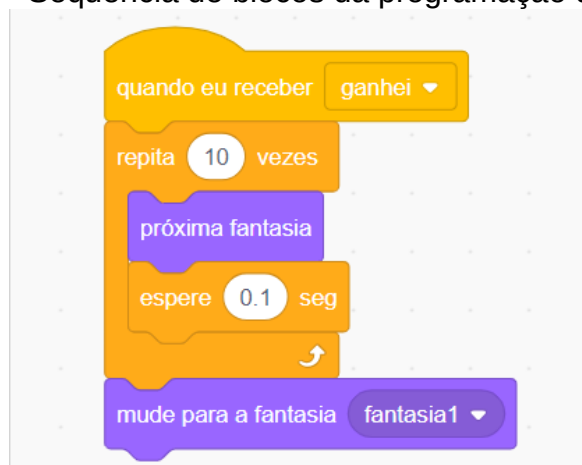
Figura 50 - Sequência de blocos da programação das sirenes
