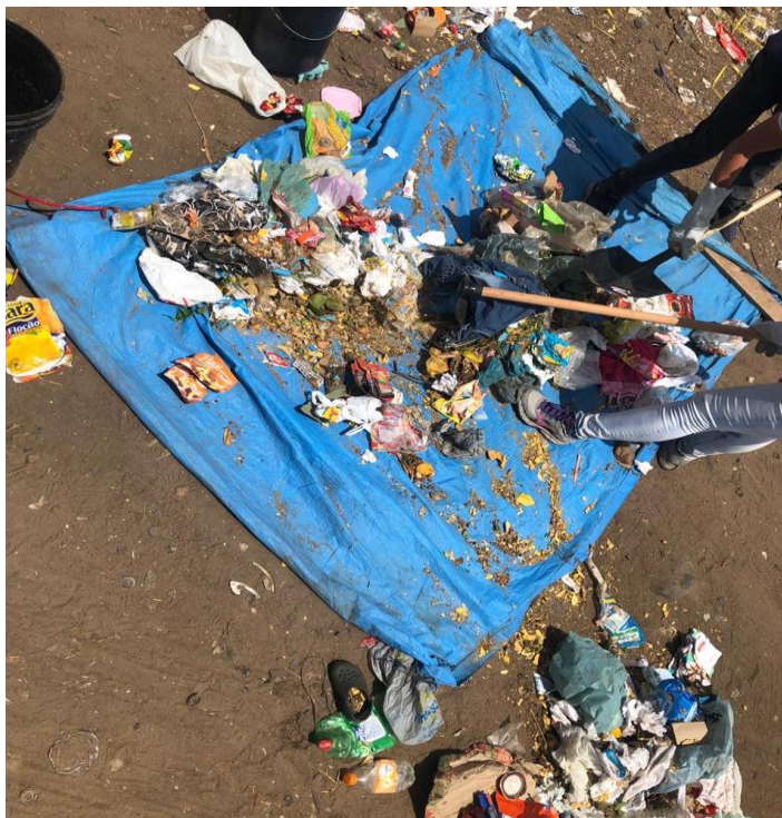
Figura 12: Homogeneização da amostra
