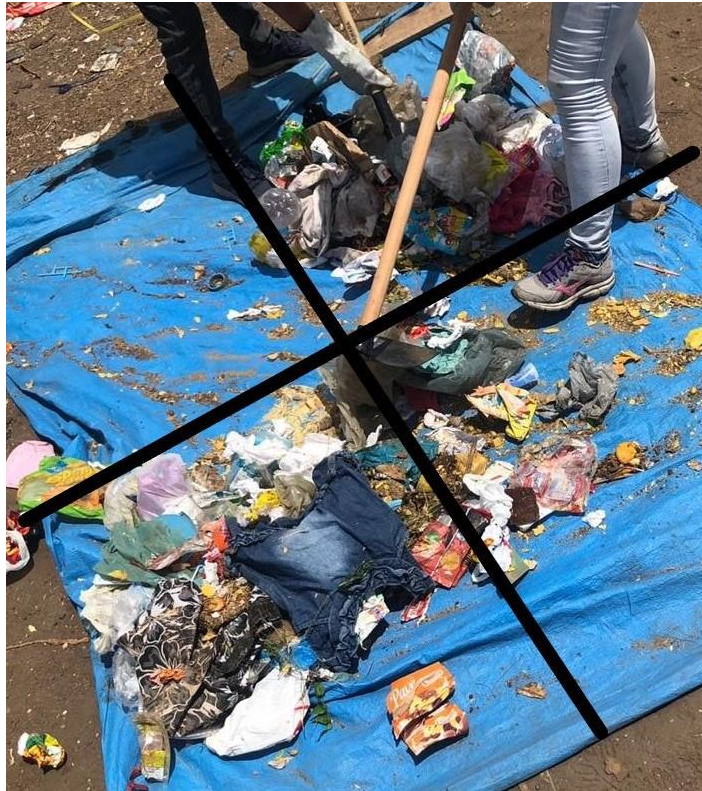
Figura 11: Quarteamento da amostra
