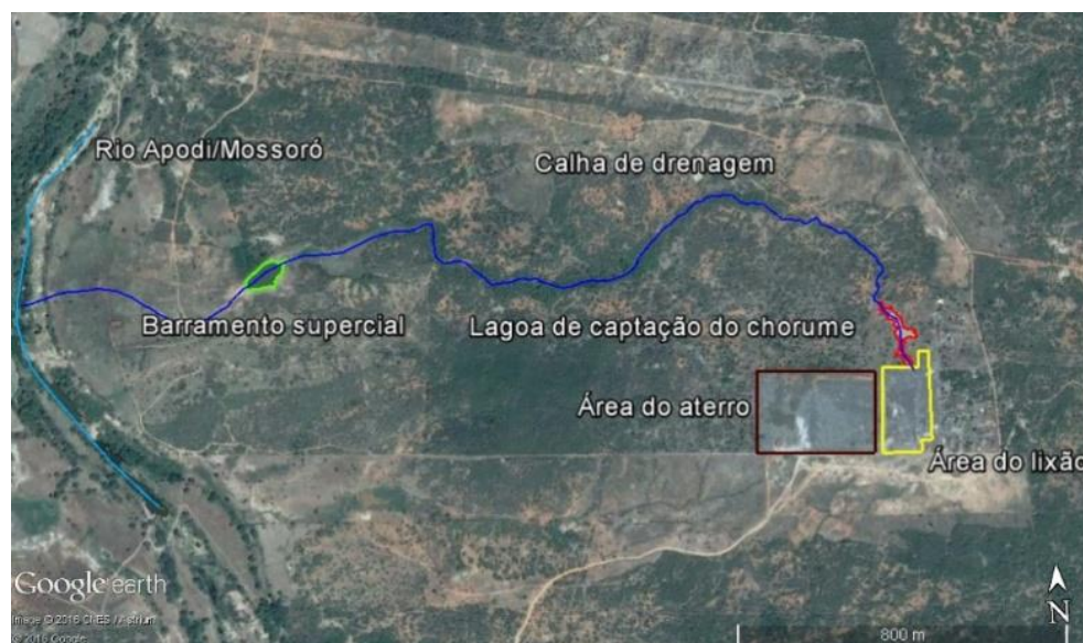
Figura 16: Caminho percorrido pelo lixiviado gerado no lixão de Pau dos Ferros
