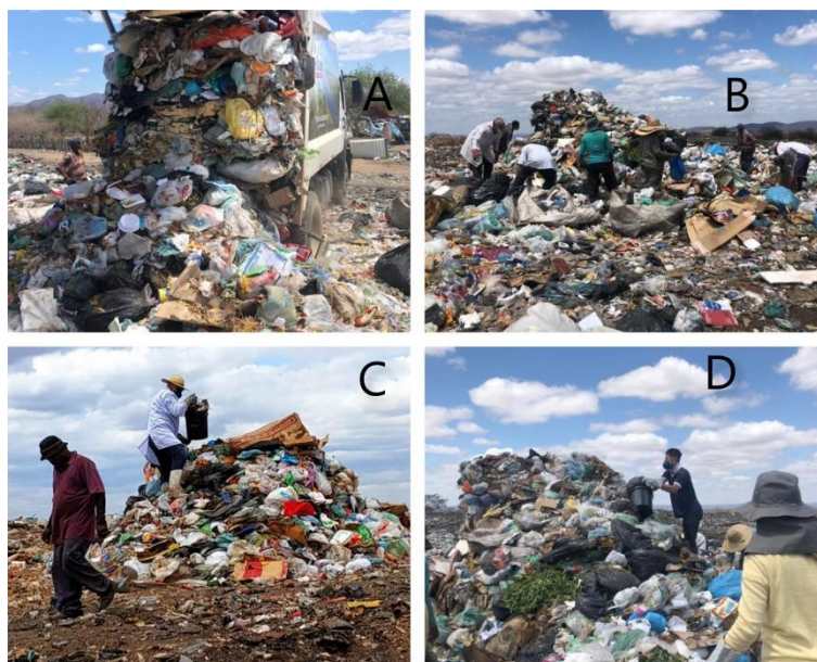
Figura 09: Coleta de amostras para gravimetria no lixão de Pau dos Ferros/RN – A) Transbordo; B) Coleta de amostra; C) Coleta de amostras; D) Coleta de amostras
