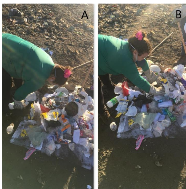
Figura 10: A) Abertura das sacolas; B) Homogeneização
