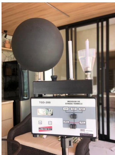
Figura 10. Medidor de estresse térmico utilizado, modelo TGD-200
