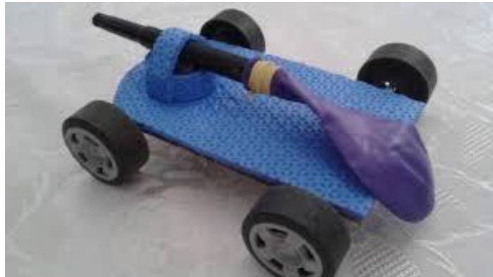
Figura 1: Carrinho movido a ação e reação.
