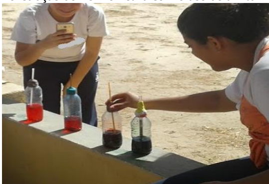
Figura 4.1: Demonstração de Termometria com o uso de um termômetro caseiro .
