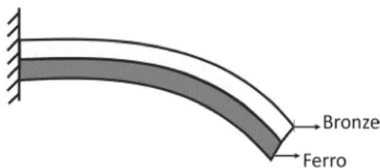
Figura 2: Representação de uma lâmina bimetálica de ferro e bronze com temperatura elevada.
