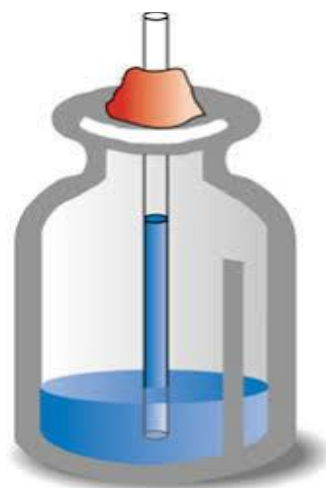
Figura 1: Representação de um Termoscópio caseiro.
