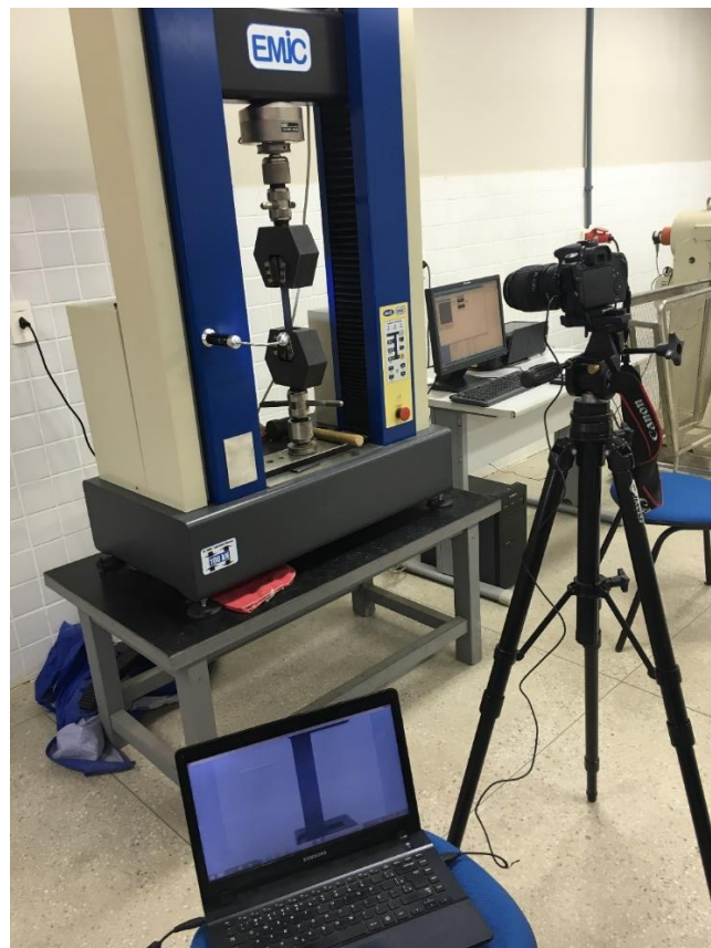
Figura 13 - Aparato utilizado no método de correlação de imagens digitais
