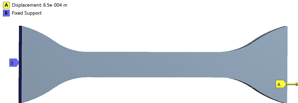
Figura 26 - Representação das condições de contorno na simulação do ensaio de tração
