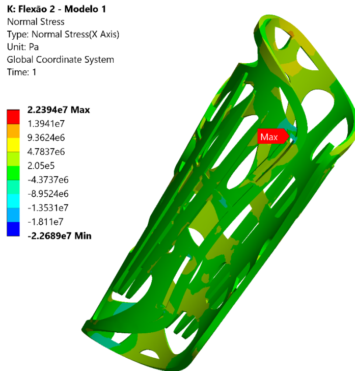
Figura 81 - Resultado da análise de forças normais na estrutura do modelo 1 na simulação de flexão longitudinal
