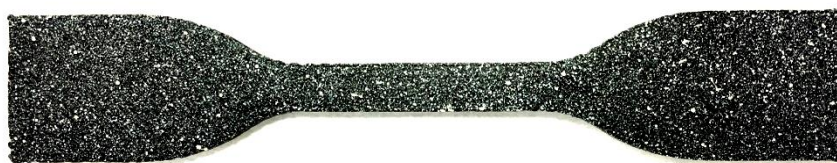
Figura 22 - Corpo de prova regulamentado pela norma ASTM D638 - 14, modelo 4, com texturização adequada para proceder o método de correlação de imagens digitais
