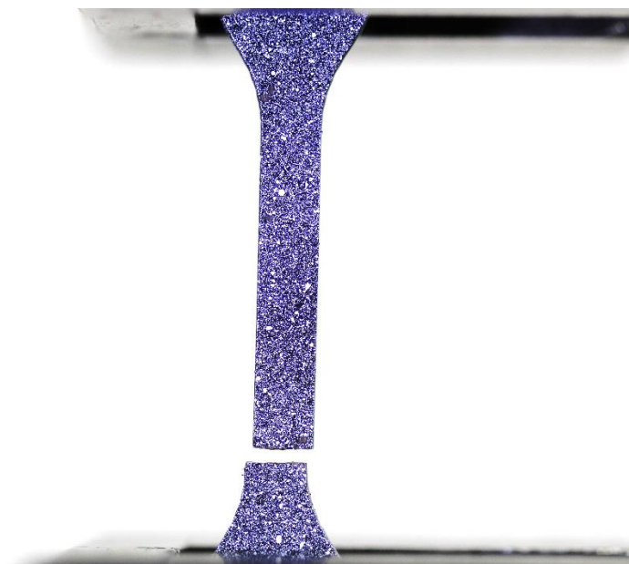
Figura 51 - Região de quebra dos corpos de prova confeccionados segundo a norma ASTM D638 - 14
