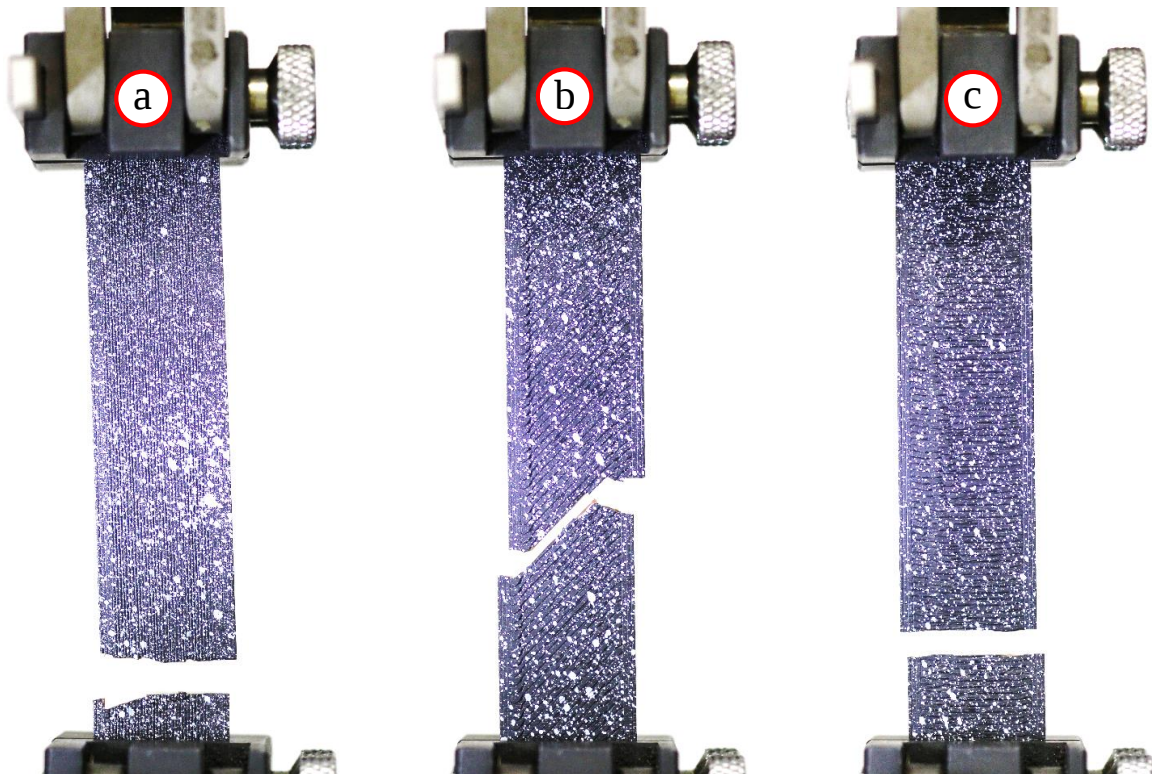
Figura 47 - Região de ruptura dos corpos de prova com fios orientados a 0^\circ (a), 45^\circ (b) e 90^\circ (c)
