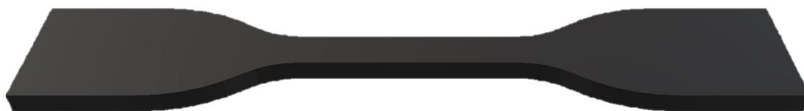
Figura 24 - Modelo de corpo de prova (descrito na norma ASTM D638 - 14) tomado como base na simulação da análise de tração do PLA
