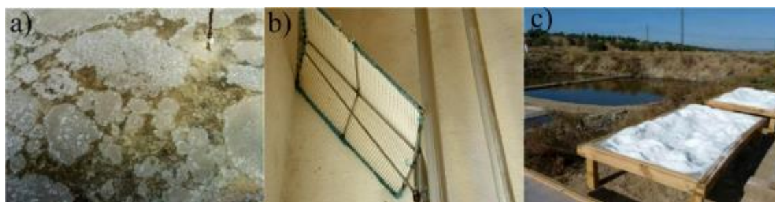
Figura 7 - Produção de FS. FS formada no cristalizador a), ferramenta usada para coleta da FS b) e secagem da FS c).
