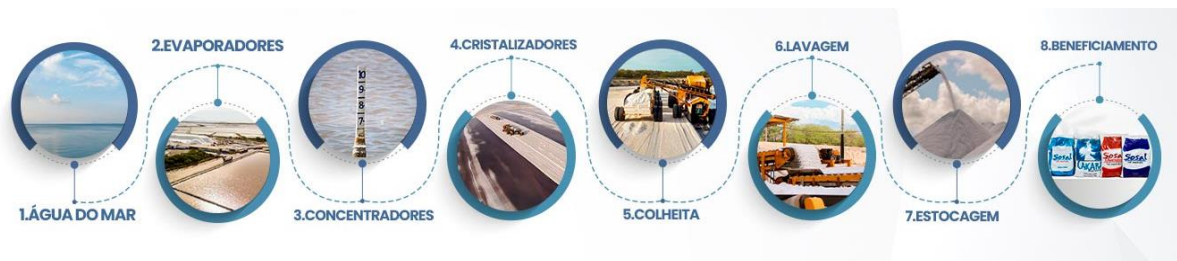
Figura 3 – Representação esquemática do processo de produção de sal (1) Água do mar, (2) Evaporadores, (3) Concentradores, (4) Cristalizadores, (5) Colheita, (6) Lavagem, (7) Estocagem e (8) Beneficiamento.
