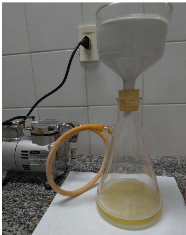
Figura 15 – Sistema de bomba a vácuo
