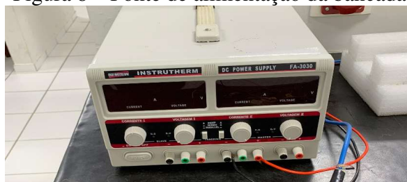
Figura 8 – Fonte de alimentação da bancada
