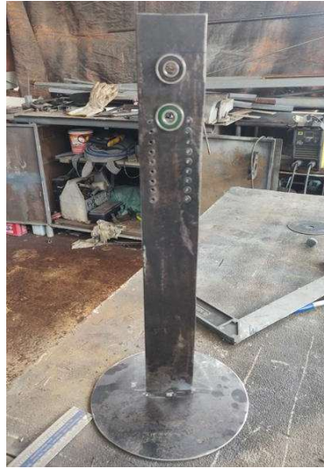
Figura 10 – Base do protótipo feito em aço carbono (Metalon®)
