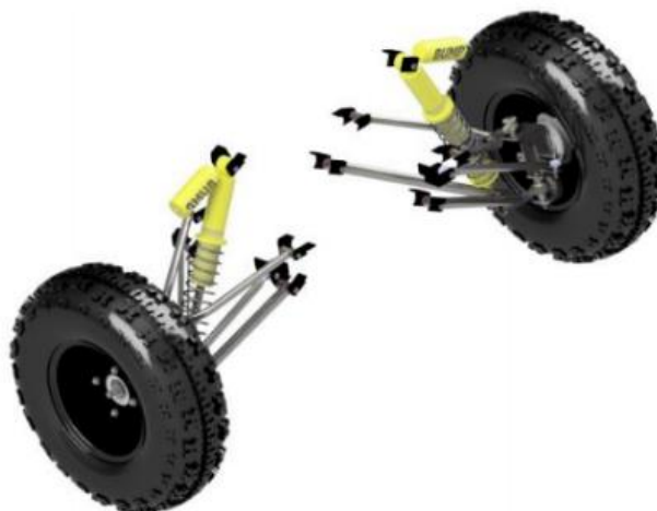
Figura 26: Modelagem dos itens de suspensão do veículo SEVERO18/19
