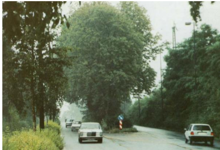
Figura 12: Vegetação produzindo o efeito de largura ótica
