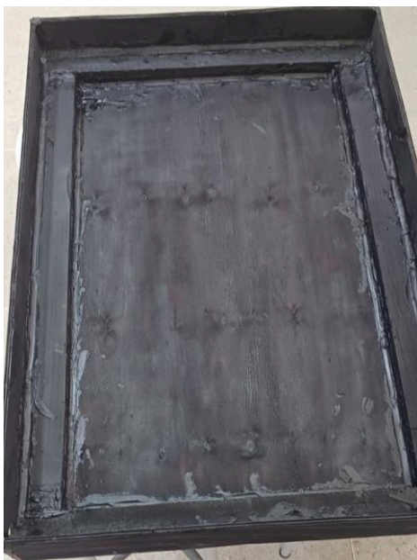
Figura 13: Caixa completamente vedada e pintada de preto.
