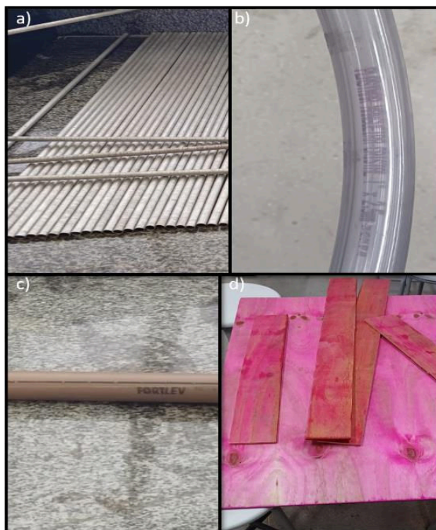
Figura 9: Materiais utilizados para a fabricação do coletor, em a) Tubos de alumínio, b) mangueira cristal, c) tubos e redução de PVC, d) madeira.
