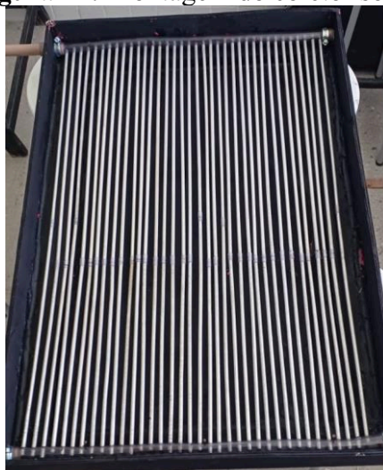
Figura 14: Montagem do coletor solar.
