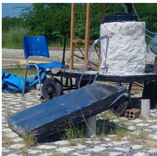
Figura 18: Sistema de aquecimento solar de água finalizado.
