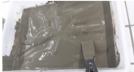
Figura 02. Pasta do cimento CP – II relação A/C 0,50 (Autoria Própria, 2022)
