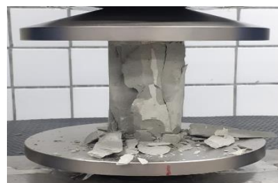
Figura 07. Bloco de CP IV, A/C 0,5, rompido. (Autoria Própria, 2022)
