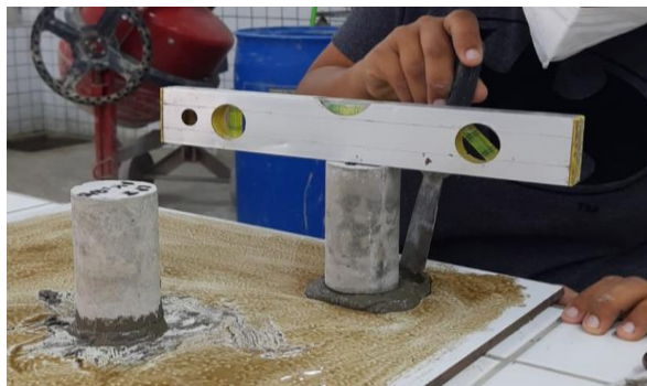
Figura 05. Processo de retificação dos corpos de prova (Autoria Própria, 2022)
