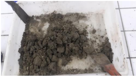
Figura 01. Pasta do cimento CP – IV relação A/C 0,30 (Autoria Própria, 2022)
