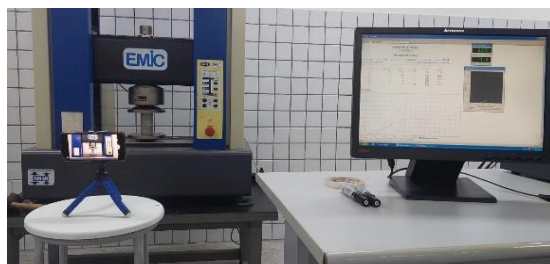
Figura 06. Aparelhagem para ensaio de compressão. (Autoria Própria, 2022)
