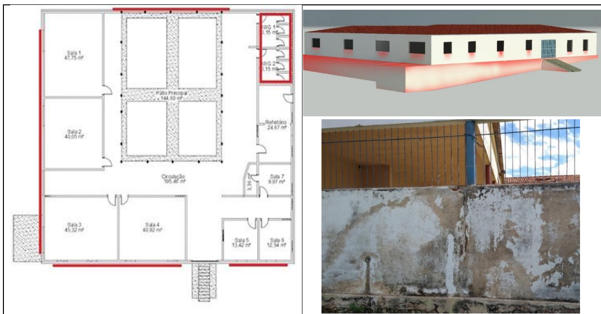
Quadro 1: Localização de eflorescências
