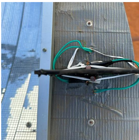
Figura 3. LDR's instalados na estrutura do PTC
