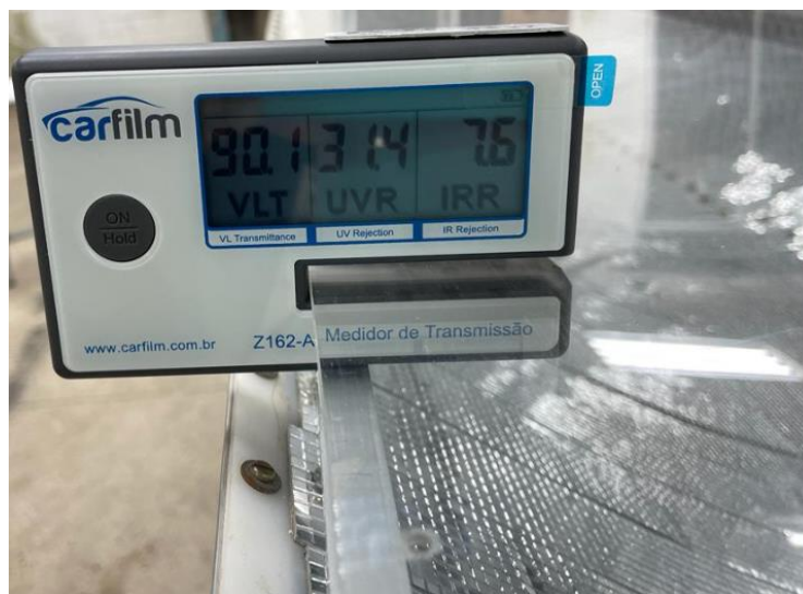
Figura 14. medidor de transmissão.
