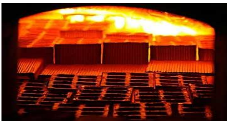
Figura 14 – Queima de peças cerâmicas
