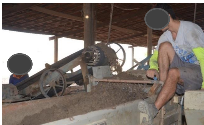
Figura 7 – Preparação da massa cerâmica
