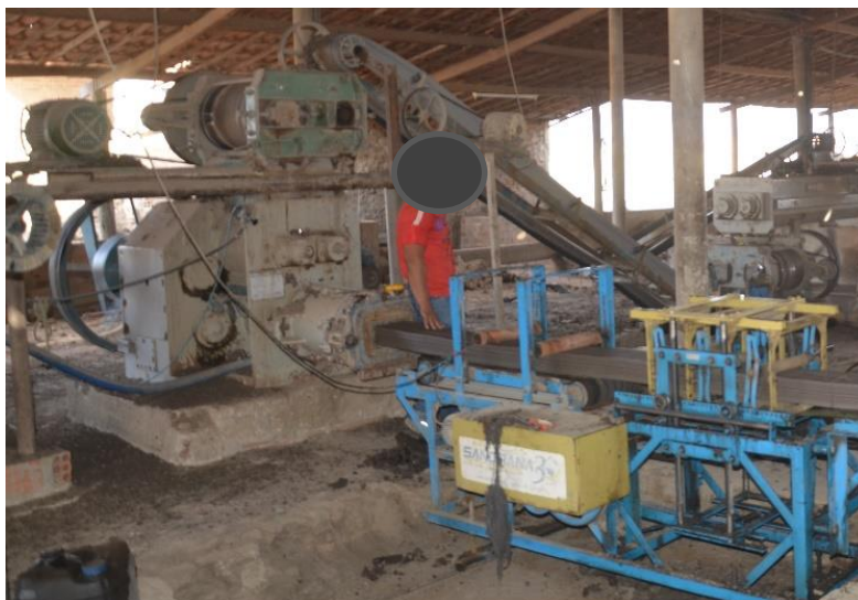
Figura 10 – Extrusão e corte do material cerâmico
