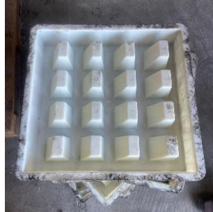
8.b: Retirada das fôrmas
