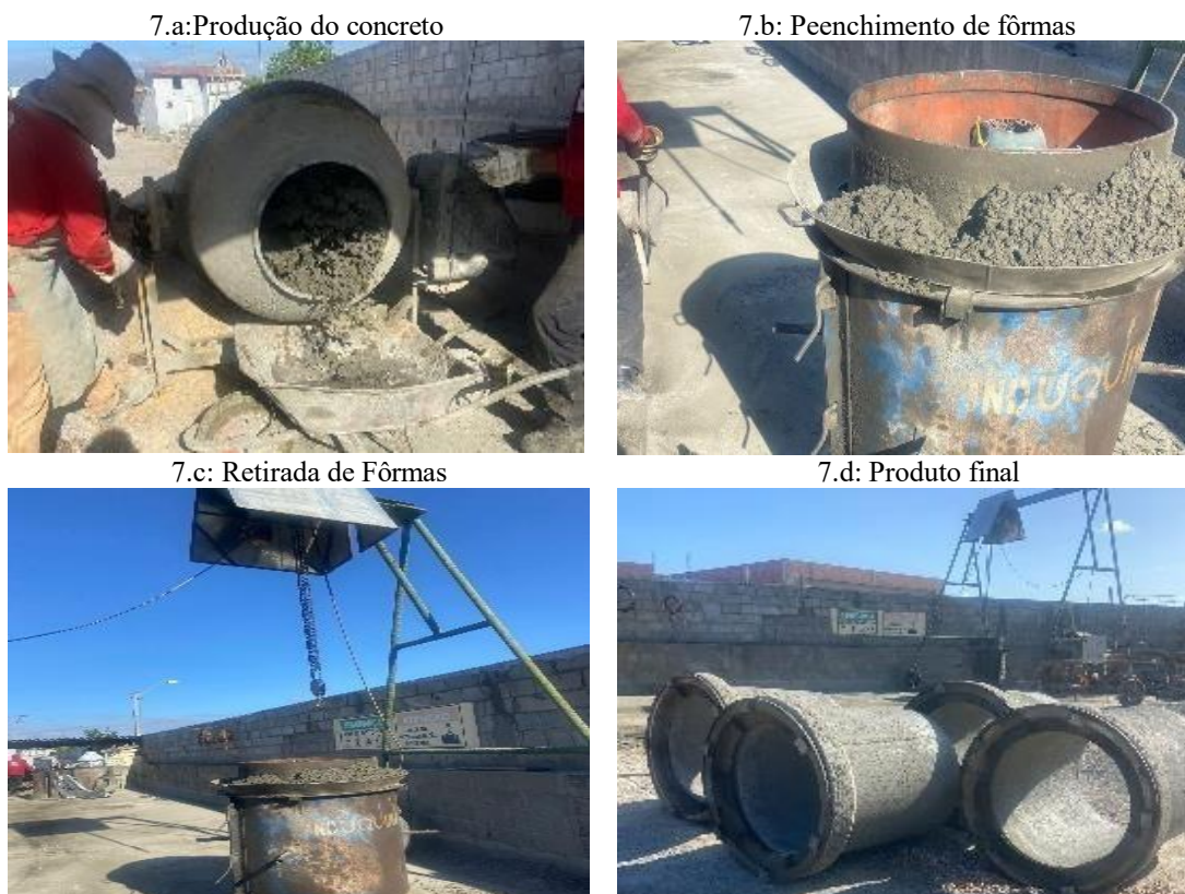
Figura 07 - Processo de produção de anéis de concreto
