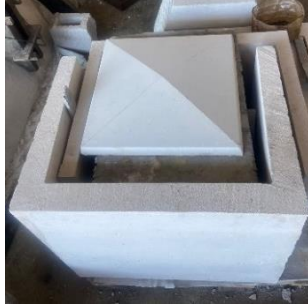
8 a: Preenchimento das fôrmas
