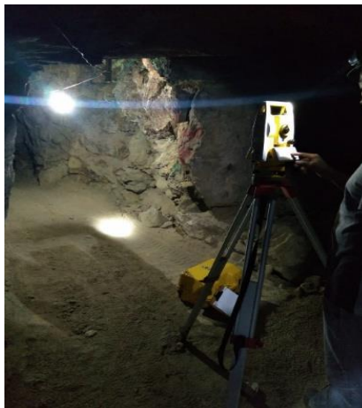
Figura 16 - Levantamentos topográficos no interior da mina
