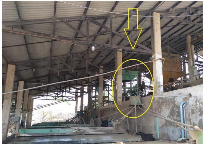
Figura 9 - Scheelita descendo do jigge em direção as mesas vibratórias
