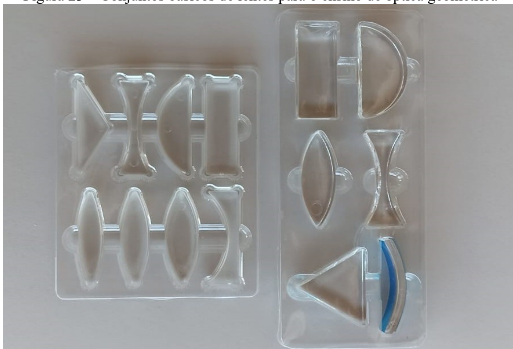
Figura 23 – Conjuntos básicos de lentes para o ensino de óptica geométrica
