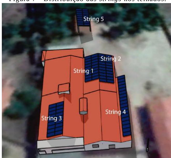
Figura 7 - Distribuição das strings nos telhados.
