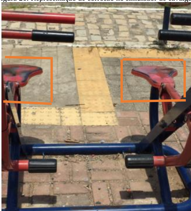
Figura 21: Representação de corrosão no simulador de cavalgada
