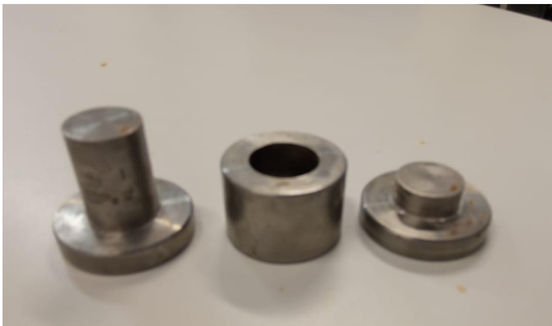
Figura 35 – Matrizes utilizadas para prensagem das pastilhas cilíndricas.
