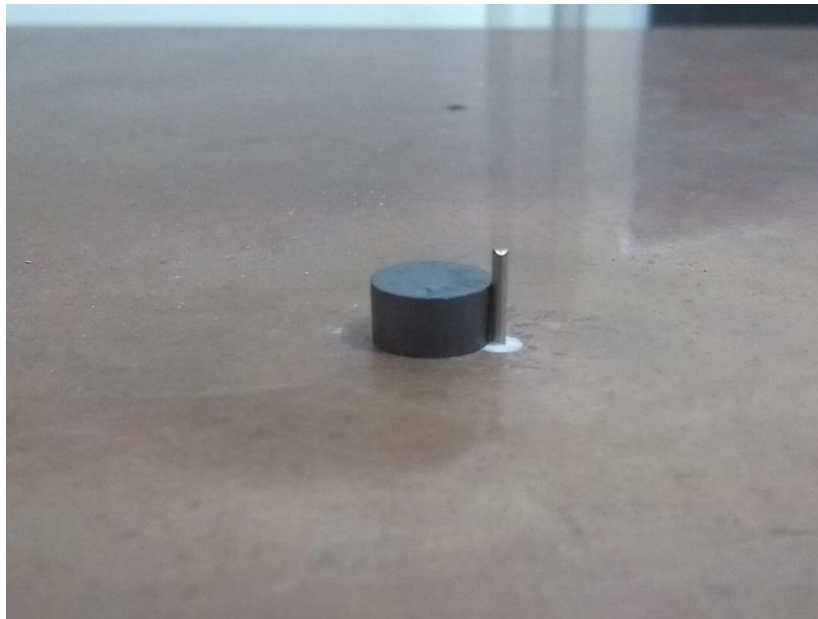
Figura 55 - Estrutura de medição da antena DRA.
