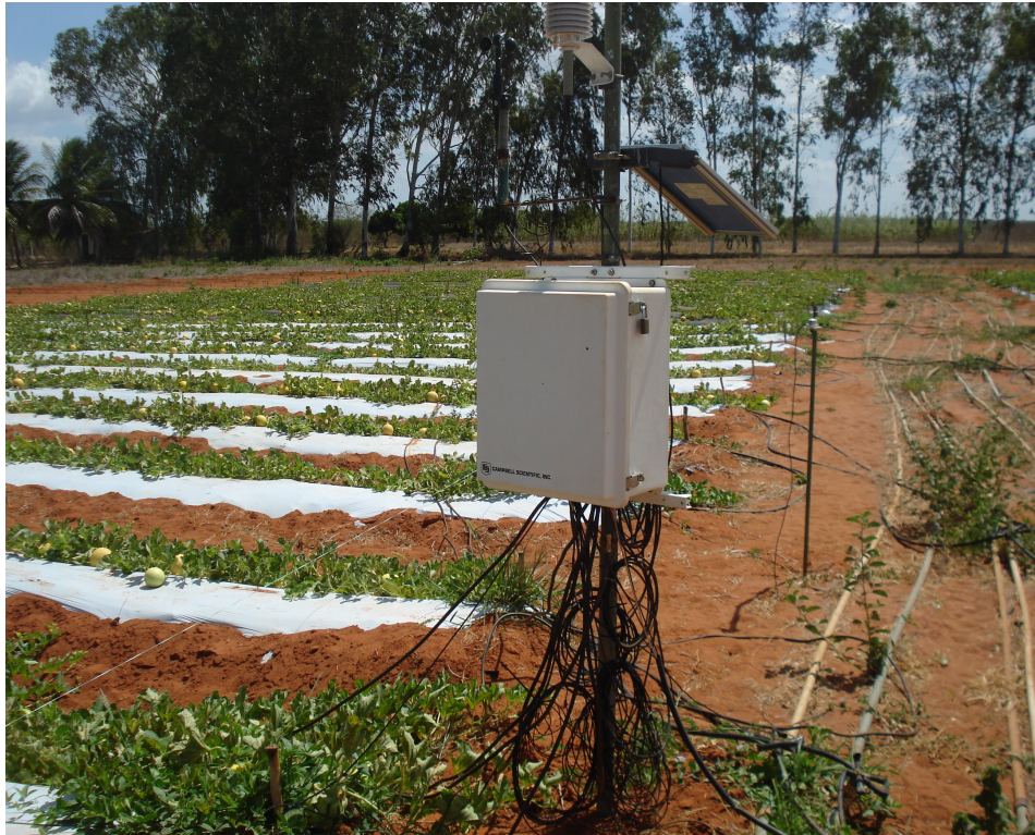
Figura 4. Estação Agrometeorológica automática instalada na área experimental. Mossoró - RN, 2009.
