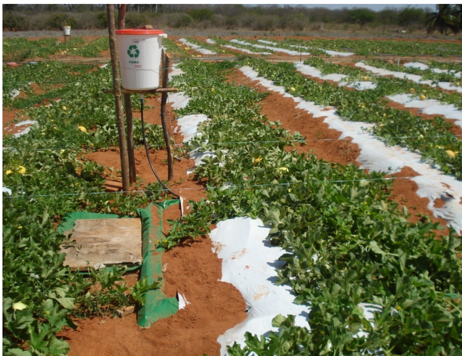
Figura 3. Detalhe da irrigação dos lisímetros instalados na área. Mossoró - RN, 2009.
