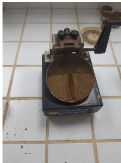
Figura 21: Aparelho de Casagrande com a Amostra.
