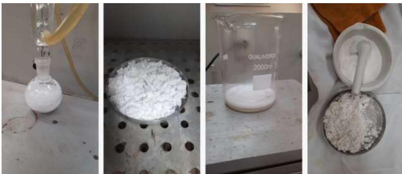
Figura 3: Processo de síntese dos tensoativos.
