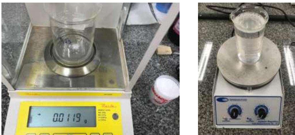
Figura 4: Preparação das soluções de tensoativos.
