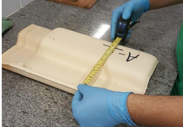
Figura 14: Medição de largura efetiva
