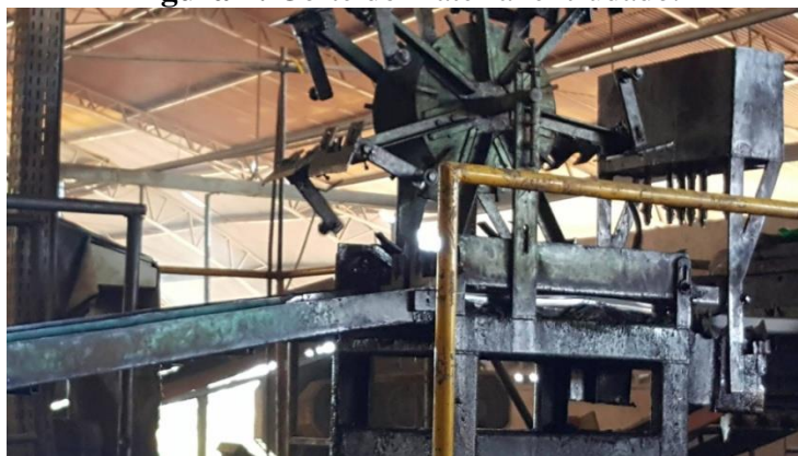
Figura 4: Corte do material extrudado.
