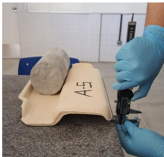
Figura 17: Ensaio de planaridade
