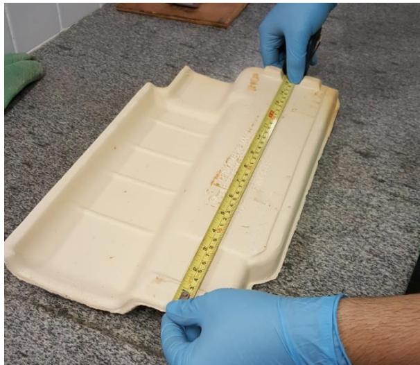
Figura 15: Medição da posição do pino
