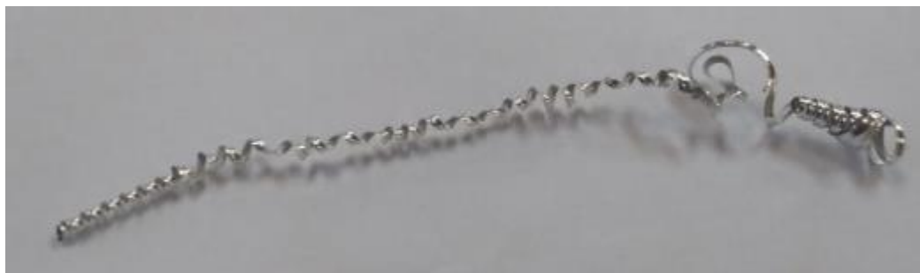
Figura 26 – Tipo de cavaco obtido
