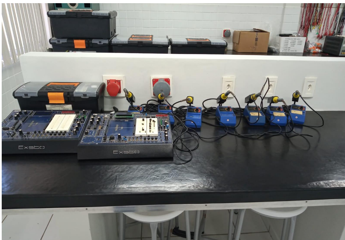
Figura 08: Tomadas na Bancada no Laboratório de Instalações e Máquinas
