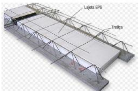
Figura 8: Aplicação do bloco de EPS em lajes treliçadas.
