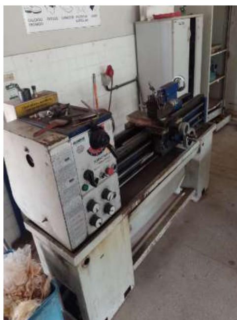
FIGURA 7. (a) Máquina de solda Origo Tig 150HF 5,3kVA e 36A; (b) Torno mecânico de bancada Manrod MR-302 de 2 HP ou 1,49kW. Fonte: (Autoria Própria).
