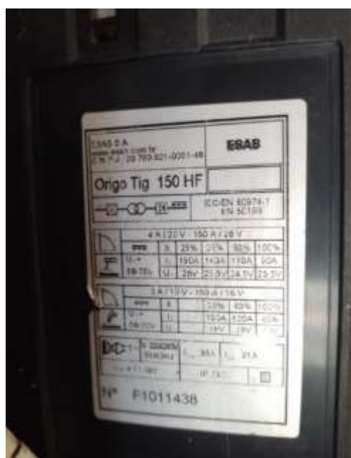
FIGURA 7. (a) Máquina de solda Origo Tig 150HF 5,3kVA e 36A; (b) Torno mecânico de bancada Manrod MR-302 de 2 HP ou 1,49kW. Fonte: (Autoria Própria).
