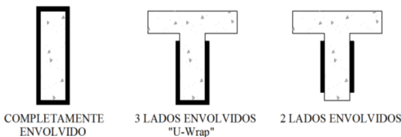
Figura 2 –Tipos de envolvimento para o dimensionamento do reforço à cisalhamento com CFC.
