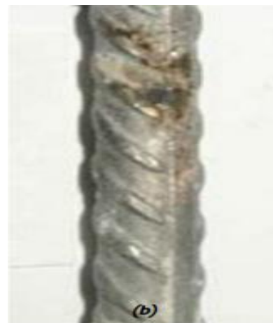
Figura 1- Aparência superficial da corrosão generalizada desencadeada pela carbonatação do concreto(a) - Corrosão puntiforme desencadeada pela ação dos íons cloreto (b)
