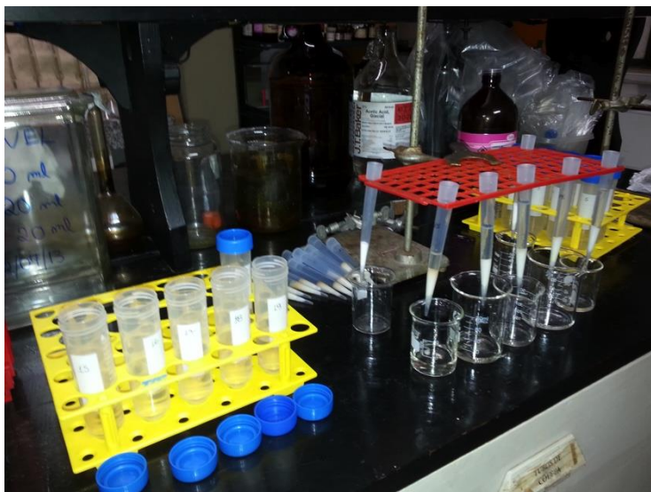
Figura5. Tubos de propileno com os extratos e cartuchos com floril e sulfato de magnésio para filtração das amostras.
