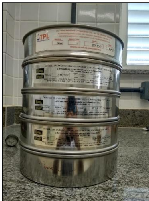
Figura 13 - Peneiras usadas para determinar granulometria das esferas.
