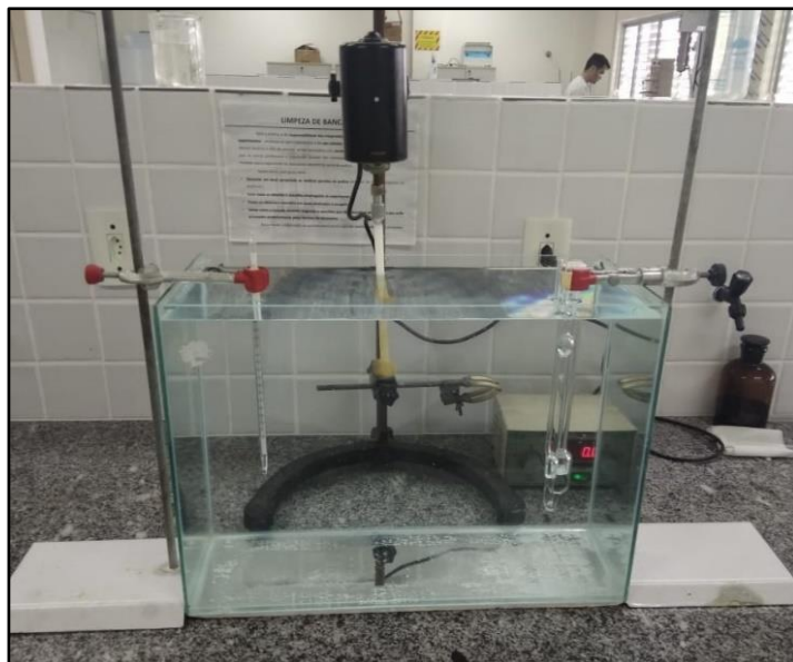
Figura 10: Sistema montado para obtenção da massa molar média.
