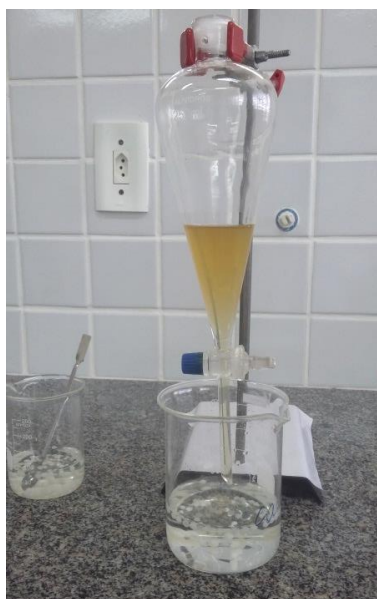
Figura 11: Aparato usado para gotejar a solução de quitosana 4%.
