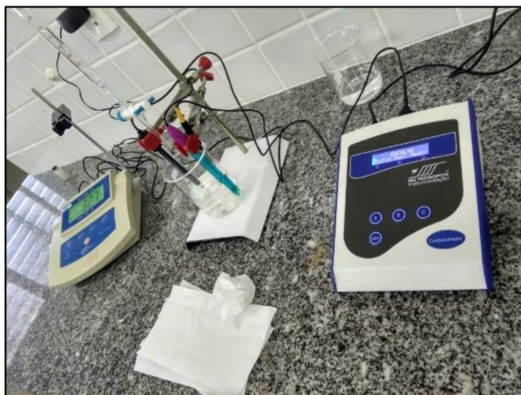
Figura 9: Sistema montado para titulação condutimétrica.
