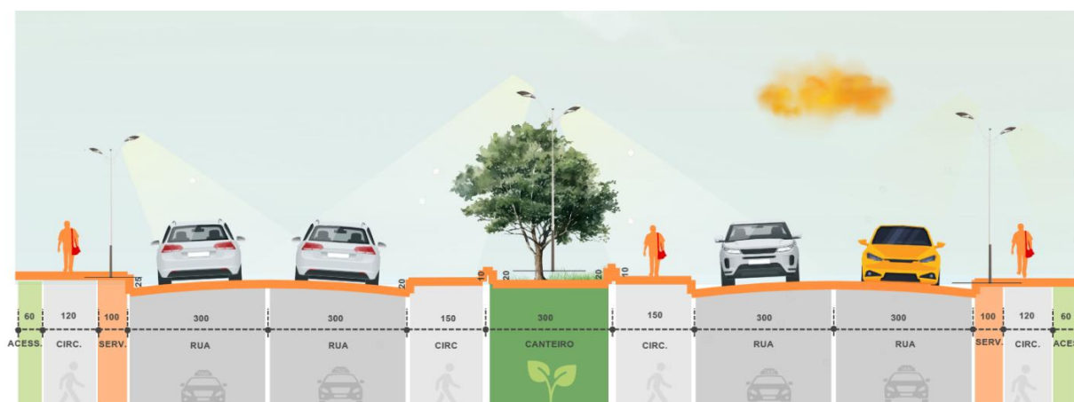
Figura 34 – Corte e Planta Humanizada para futuras vias de até 24m
