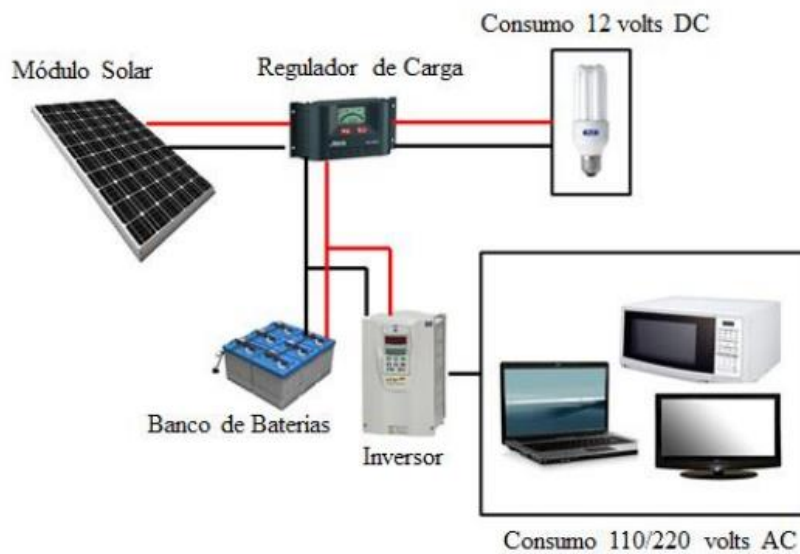
Figura 6: Sistema típico de energia solar fotovoltaica
