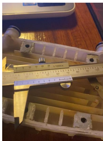
Figura 11: Massa epóxi instalada na parte principal da resistência.
