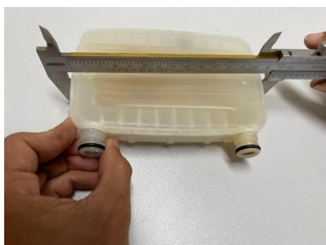
Figuras 9A: Medição do comprimento da resistência.
