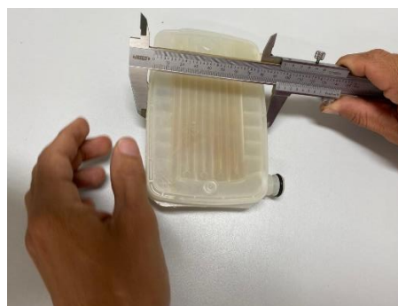
figura 9B: Medição da largura da resistência.
