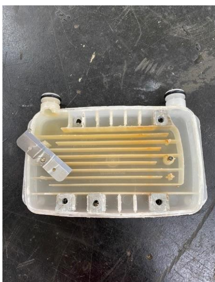
Figura 10: Parte principal da resistência com Epóxi bi.
