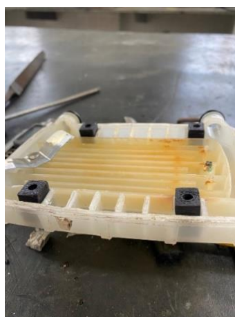
Figura 14: Parte principal da resistência com bloco ABS acoplado.
