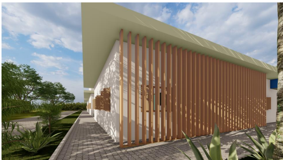
Figura 33- Brises e marquises.
