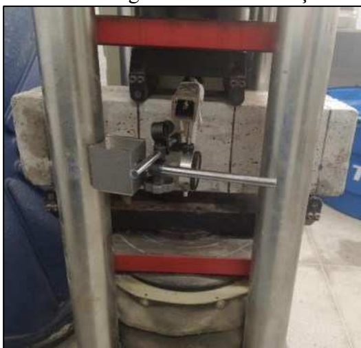
Figura 16 - Montagem do ensaio a tração na flexão
