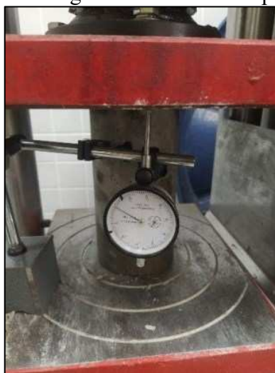
Figura 15 - Montagem do ensaio a compressão axial
