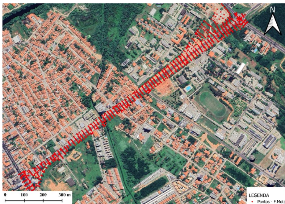
Figura 2 – Pontos do levantamento com o GNSS RTK X91 . Autor (2024).
