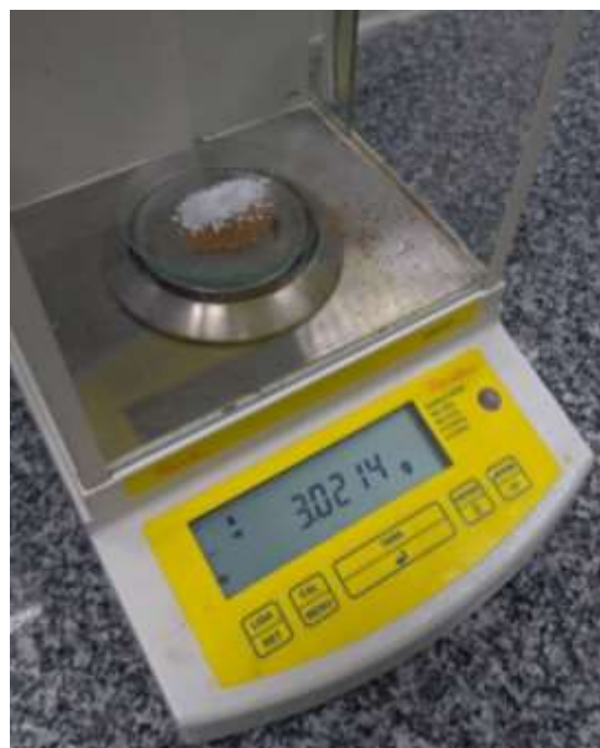
Figura 17 – Pesagem da casca e do sulfato
