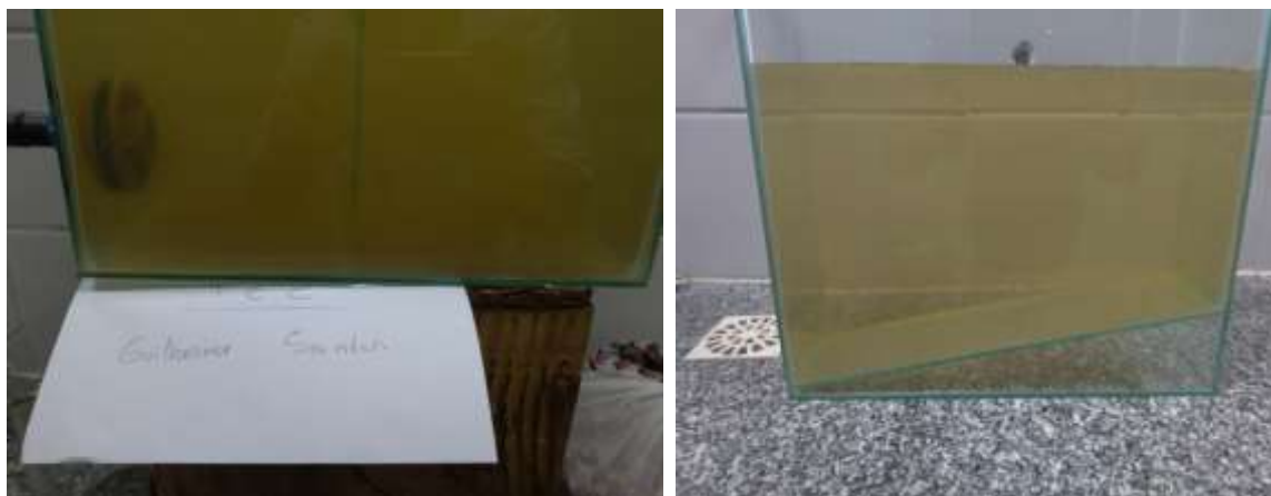
Figura 18 - Antes e Depois da adição do sulfato de alumínio no ensaio I
