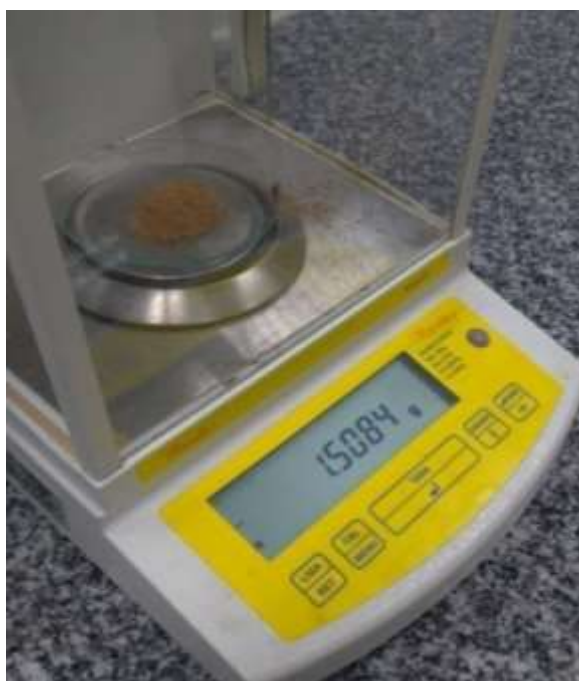
Figura 17 – Pesagem da casca e do sulfato
