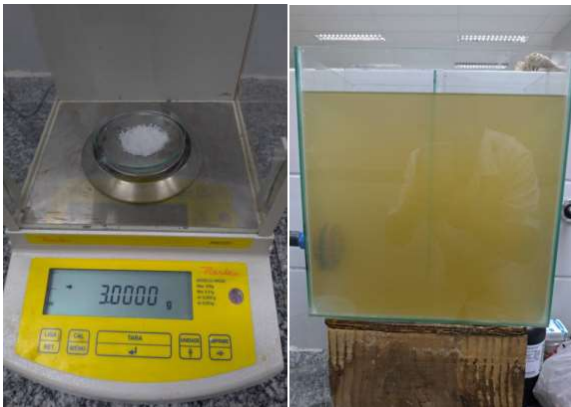
Figura 12 - Pesagem do sulfato de alumínio e a adição na água
