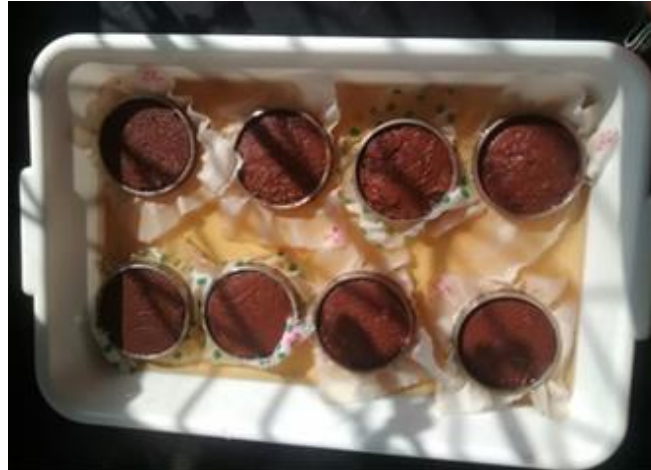
Figura 4. Batelada de amostra de solo em saturação.
